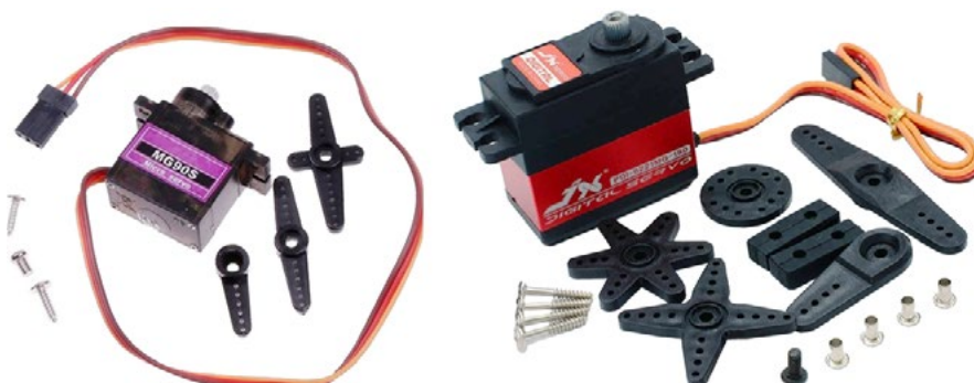
Рис. 19. Серводвигатели MG90S и PDI-6221MG-180
