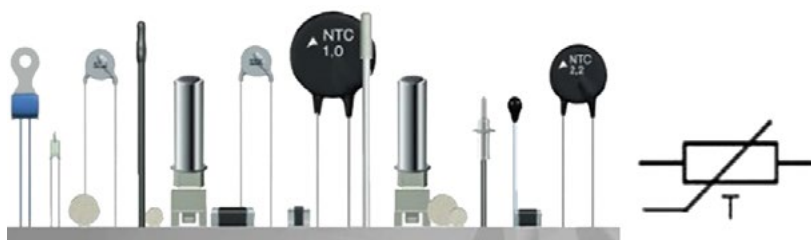
Рис. 11. Терморезисторы и их обозначение
