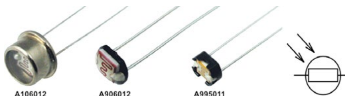
Рис. 12. Фоторезисторы и их обозначение
