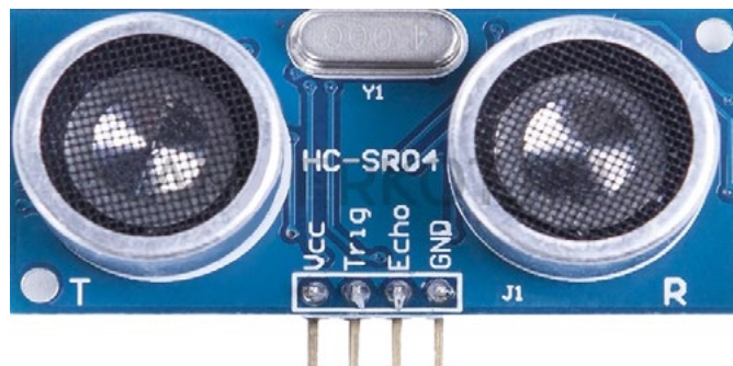
Рис. 16. Ультразвуковой датчик (дальномер)
